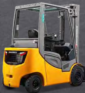
Spalinowy wózek widłowy z silnikiem na gaz/olej napędowy z przekładnią hydrostatyczną DFG/TFG 316s-320s maks. wys. podn.: 7500 mm maks. udźwig: 2000 kg
