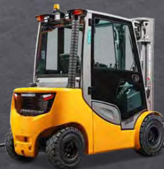
Spalinowy wózek widłowy z silnikiem na gaz/olej napędowy z przekładnią hydrostatyczną DFG/TFG 425s-435s maks. wys. podn.: 7500 mm maks. udźwig: 3500 kg
