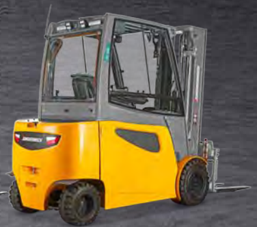
Akumulatorowy czterokołowy wózek widłowy EFG 425-S30s maks. wys. podn.: 7000 mm maks. udźwig: 3000 kg
