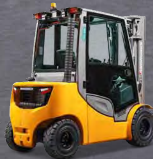
Spalinowy wózek widłowy z silnikiem na gaz/olej napędowy z przekładnią hydrodynamiczną DFG/TFG 425-435 maks. wys. podn.: 7500 mm maks. udźwig: 3500 kg
