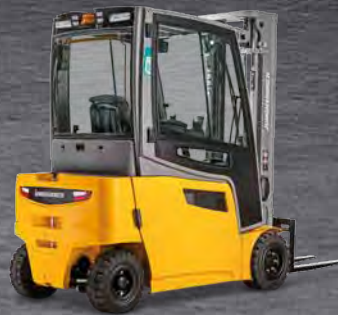
Akumulatorowy czterokołowy wózek widłowy EFG 316-320 maks. wys. podn.: 6500 mm maks. udźwig: 2000 kg
