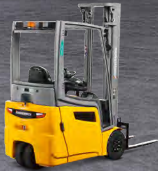
Akumulatorowy trójkołowy wózek widłowy z napędem przednim EFG 213-220 maks. wys. podn.: 6500 mm maks. udźwig: 2000 kg
